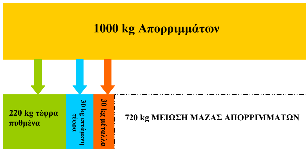
Σχήμα 2: Σχηματική αναπαράσταση της μείωσης μάζας των απορριμμάτων κατά την Καύση
